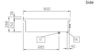
Electrical inlet (power) **Equipotential screw**
